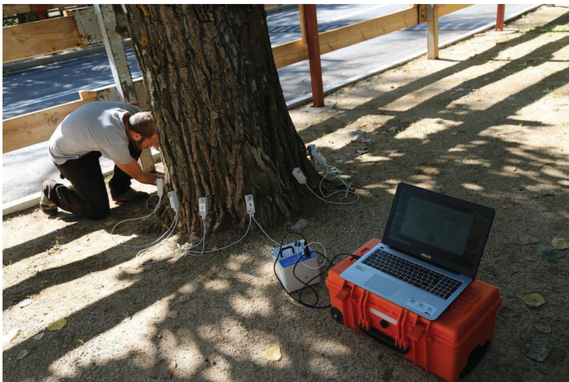
Colocación de tomógrafo sónico
