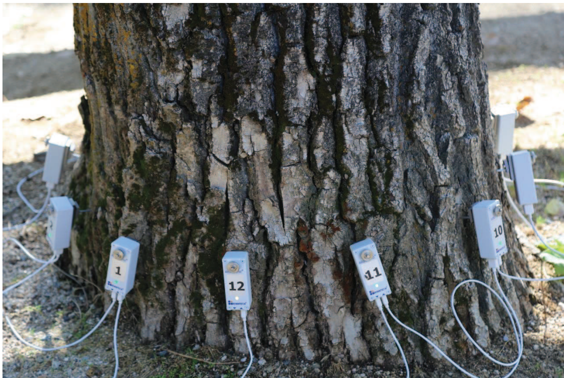
Colocación de sensores del tomógrafo sónico en chopo de la Avenida de Madrid
